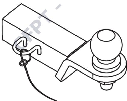
Passar o cabo através do ponto de fixação e de seguida prender o cabo a si mesmo
