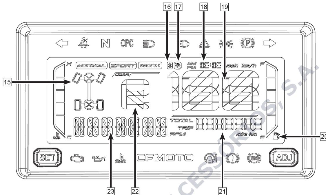
**15. Método De Condução** - indica o método de condução escolhido entre 2wd, 4wd, ou 4wd- lock
