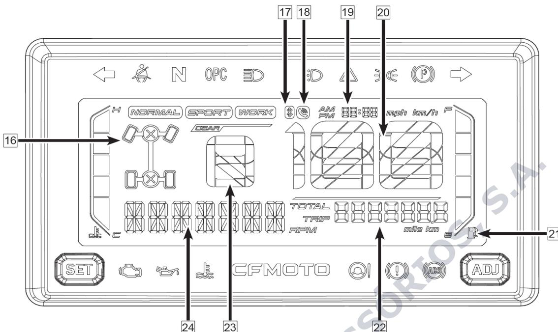
**16. Método De Condução** – indica o método de condução escolhido entre 2wd, 4wd, ou 4wd- lock
